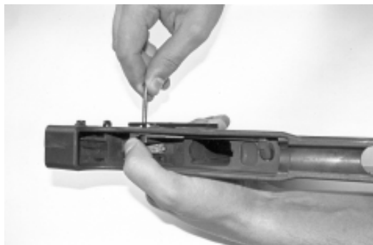
Рис. 24. Установка шептала, перехвата и фиксатора
