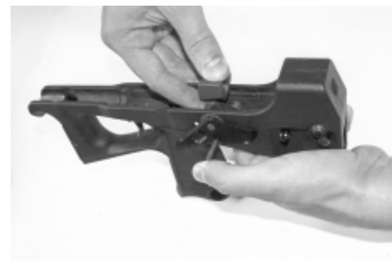
Рис. 27. Установка оси курка
