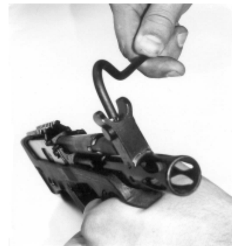
Рис. 12. Ввинчивание (вывинчивание) мушки
