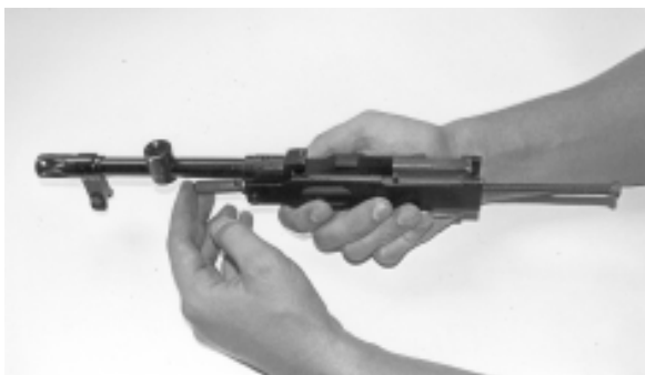
Рис. 18. Установка затвора в ствольную коробку
