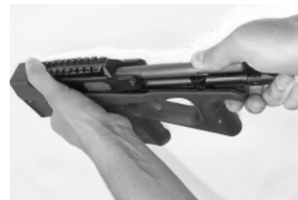
Рис. 21. Фиксация ствольной коробки на рукоятке
