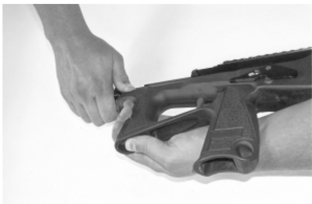
Рис. 15. Отсоединение ствольной коробки от рукоятки
