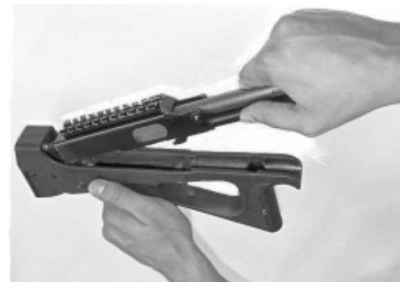
Рис. 19. Введение выступающей части штока внутрь рукоятки
