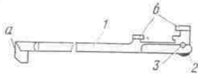
Рис. 45. Рукоятка перезарядки: 1 — основание; 2 — ролик рукоятки; 3 — ось ролика; а — зацеп; б — выступы
