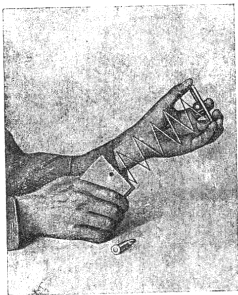
Рис. 61. Вынимание пружины магазина.
